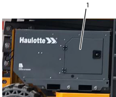
R a n g e E x t e n d e r — 1
